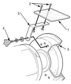
FIGURE 3. INSTALLING THE EYE SHIELD
